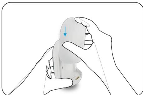
Schieben Sie die Batterie nach unten und verriegeln Sie sie fest.
