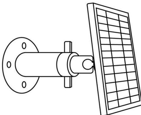
4. Lösen Sie den Einstellregler an der Halterung und stellen Sie den Winkel des Solarpanels so ein, dass es direktes Sonnenlicht empfängt, dann ziehen Sie den Einstellregler fest, um das Solarpanel zu fixieren.
