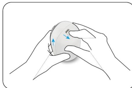
Überprüfen Sie den Status der Taste, um festzustellen, dass die Batterie richtig eingesetzt ist.
