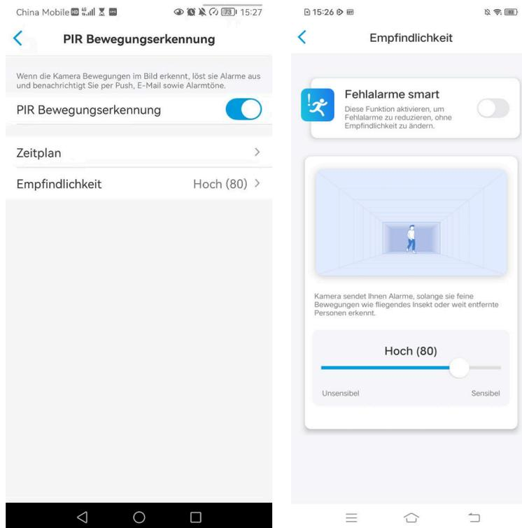
Ziehen Sie den Balken, um die Empfindlichkeit von niedrig über mittel bis hoch einzustellen, oder von 1 bis 100. Für Kameras mit digitalen PIR-Sensoren gibt es
