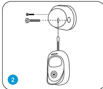
Es gibt ein Anti-Fall-Sicherheitsseil. Bitte befestigen Sie das andere Ende des Seils an der Wandhalterung, wenn Sie es an einer Wand montieren.
