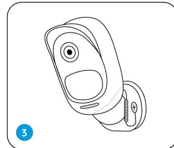
Befestigen Sie die Kamera an der Wandhalterung und drehen Sie die Kamera, um die Richtung
