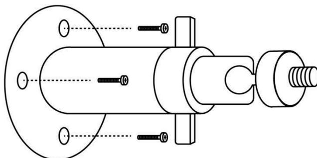
3. Setzen Sie das Solarpanel in die Halterung ein und überprüfen Sie, ob es fest sitzt.
