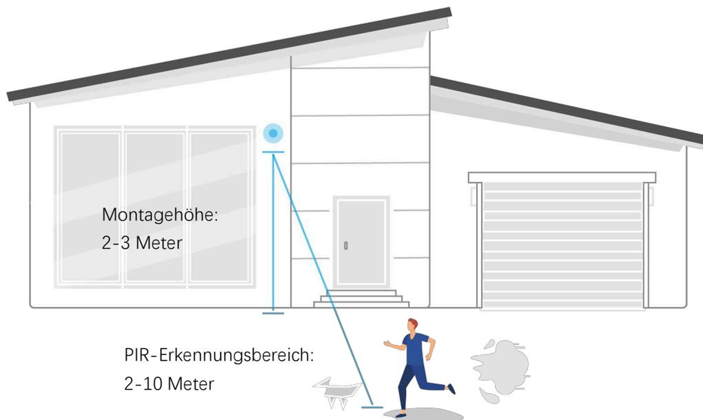
3. Es wird empfohlen, die Kamera 2 bis 3 Meter über dem Boden zu montieren. Wenn die Kamera zu niedrig oder zu hoch montiert wird, ist es schwierig, die Gefahr zu erkennen.
