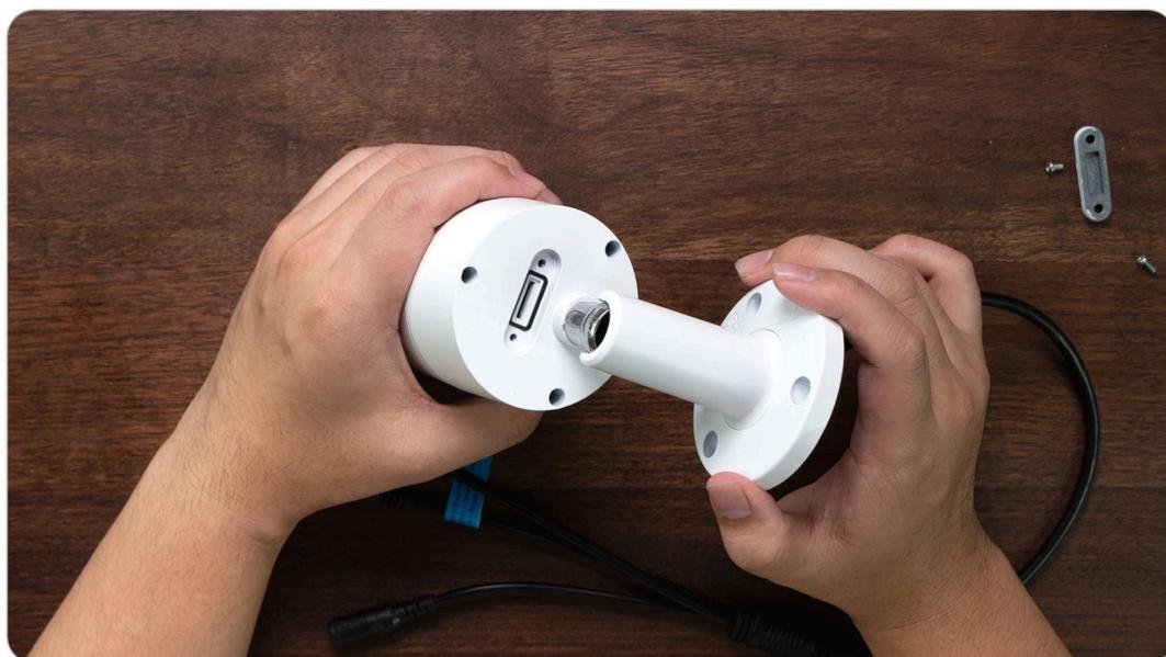
2. Legen Sie die microSD-Karte wie in der Abbildung unten ein. Bitte verwenden Sie Ihren Fingernagel (oder verwenden Sie die mitgelieferte Reset-Nadel), um die microSD-Karte einzuschieben, bis sie verriegelt ist. Sie werden ein Klickgeräusch hören und die microSD-Karte wird nicht herauspringen, wenn sie richtig eingelegt ist.
