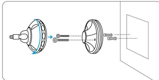
Bohren Sie die Löcher gemäß der Bohrschablone und schrauben Sie den Sockel der Halterung an die Wand. Befestigen Sie dann den anderen Teil der Halterung an dem Sockel.
