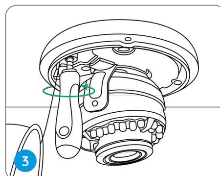
Lösen Sie die zwei Schrauben auf beiden Seiten der Kamera und stellen Sie den Blickwinkel der Kamera ein.
