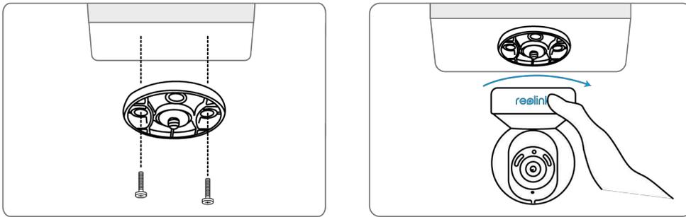
Bringen Sie die Platte an der Decke an. Richten Sie die Kamera an der Platte aus und drehen Sie die Kamera im Uhrzeigersinn, um sie zu fixieren.
