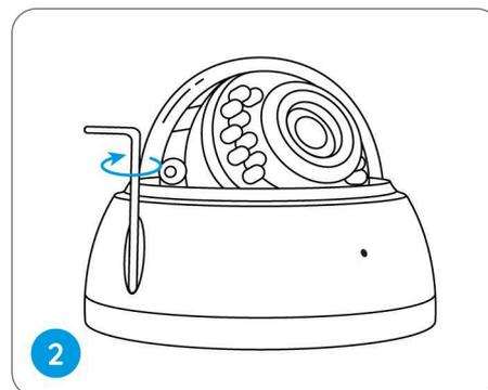
Schrauben Sie die Kamera an die Decke.
