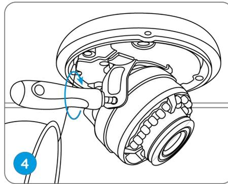
Ziehen Sie die Schrauben fest und schrauben Sie die Abdeckung wieder an die Kamera.
