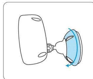
Befestigen Sie die Kamera, indem Sie das in der Grafik markierte Teil an der Halterung im Uhrzeigersinn drehen.
